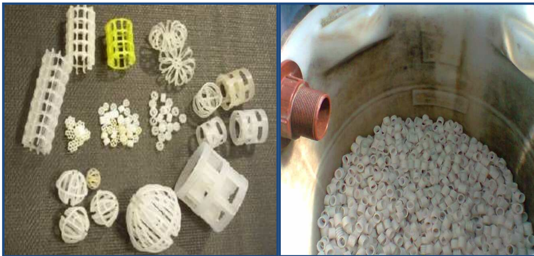
Figura 18. Distintos tipos de materiales inertes utilizados para brindar alta superficie en los sistemas de biofiltración-CENADAC.
