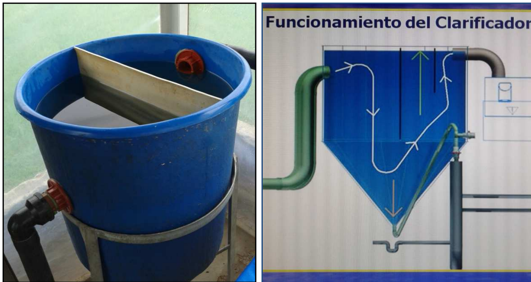
Figura 17. Diseño y funcionamiento de unidad de clarificación o decantación-CENADAC.
