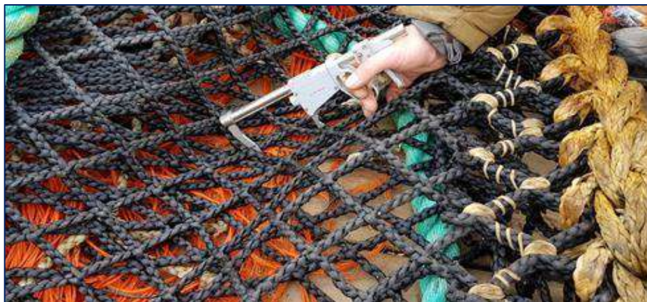
Figura 2: Medición con calibres de tensión tipo CIEM
