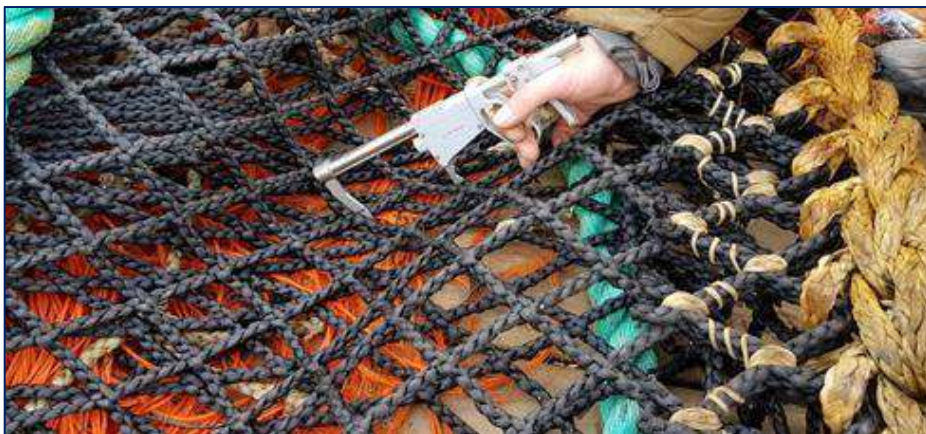
Figura 2: Medición con calibres de tensión tipo CIEM
